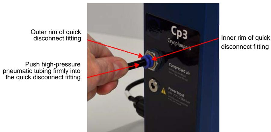
**figure 1-8.** *Pneumatic connection*
